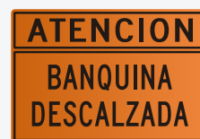
T-25 ATENCIÓN Banquina Descalzada
