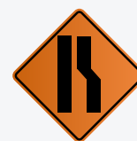
T-04 (d) Reducción de Calzada Carril Derecho
