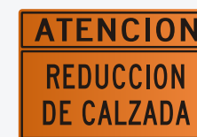
T-27 ATENCIÓN Reducción de Calzada
