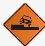
T-03 (d) Calzada en Desnivel Derecha
